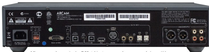
Mimo sporych rozmiarów D33, tył jest zagospodarowany – dużo wejść i wyjść a także gniazda dla zdalnego sterowania, pokazują charakter nowoczesnego DAC-a.
