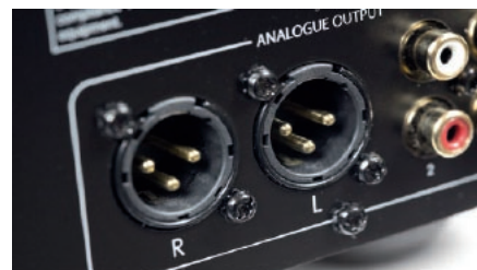
Sygnał analogowy można wysłać przez RCA jak i przez XLR – D33 jest w pełni zbalansowany.
