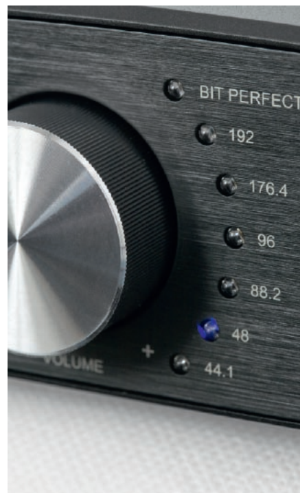
Asusy przyjmują sygnał o częstotliwości próbkowania od 44,1 kHz do 192 kHz wraz z często pomijaną 88,2 kHz – dotyczy to również wejścia USB. Temu ostatniemu służy dioda „Bit Perfect”, pokazująca, czy sygnał nie został w komputerze zamieniony.
