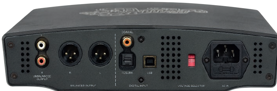
Klasyczny dla współczesnych przetworników C/A wygląd tylnej ścianki jest modyfikowany przez wyjścia zbalansowane, niezwykłe w tak niedrogiej konstrukcji.
