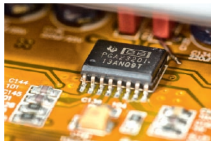
Układ odpowiedzialny za regulację siły głosu – scalona drabinka rezystorowa – jest analogowy (choć z cyfrowym sterowaniem).
