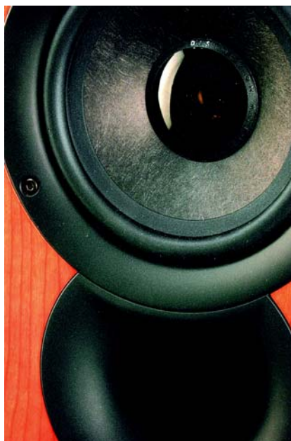
Poprzez nakładkę przeciwpylową widać miedziane pierścienie układu magnetycznego. Bas-refleks umieszczony bezpośrednio przy głośniku to motyw znany z większości KEF-ów.
