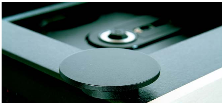
Klasycznie dla top-loadera, płyta dociskana jest przez krążek.
