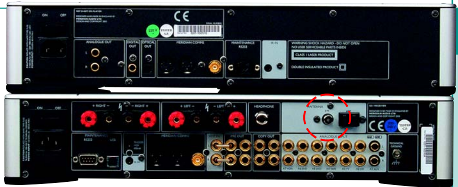
Niecodzienny widok w urządzeniu audiofilskim – gniazda antenowe wbudowanego tunera.
