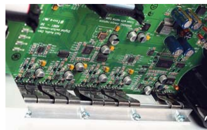
Transystory końcówki mocy zainstalowano na radiatorze w centrum obudowy.
