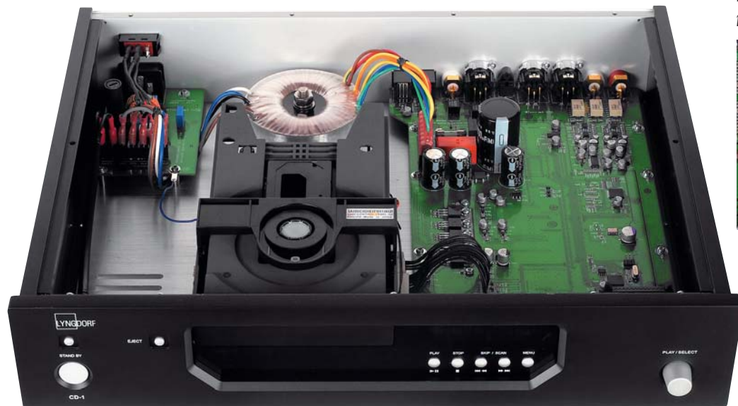
Przetwornik to układ Wolfsona, akceptujący sygnały 24 bit/ 192 kHz.
