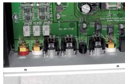
Wszystkie gniazda wlotowano bezpośrednio na płytkę, wyjścia analogowe kluczowane są przełącznikami.
