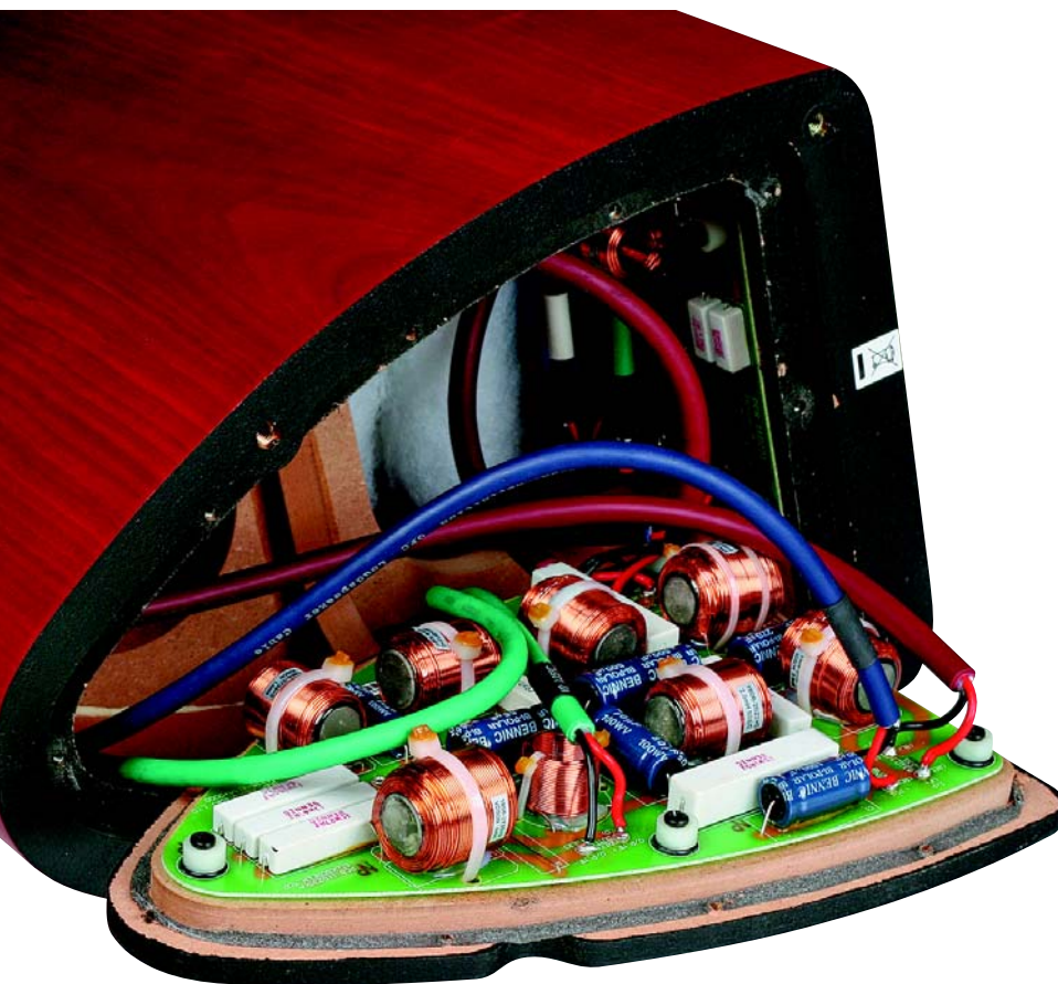
Zwrotnica bije rekordy skomplikowania. Nie zmieściła się nawet na dolnej ściance, którą zajęła w całości – w głębi widać drugą płytkę. Filtry wyższego rzędu, obwody korekcyjne, regulacje...
