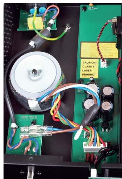
Pojedynczy transformator, zasilający cały układ odtwarzacza, odsunięto od napędu i elektroniki.
