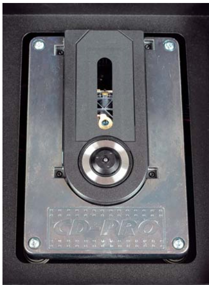
Napęd to znakomity Philips CD-Pro 2LF; jego korpus wykonano z metalowego odlewu.
