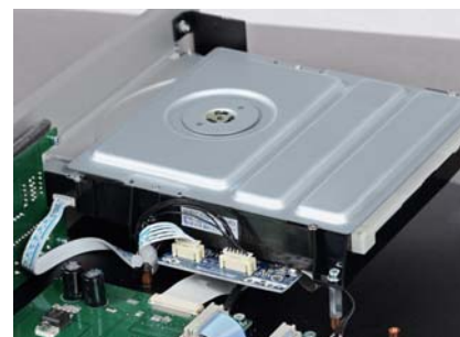
Napęd DVD-ROM z oprogramowaniem napisanym wspólnie przez Anagram Technologies i StreamUnlimited. Taki zestaw sprzedawany jest w systemie OEM po nazwę BlueTiger CD-80.
