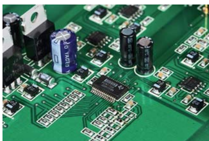
Przetwornik cyfrowo-analogowy to układ Burr-Browna PCM1794.
