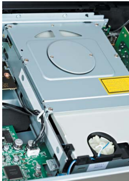
Mechanizm zabudowano ekranami i elastycznie połączono z podłożem, prowadnice są metalowe.
