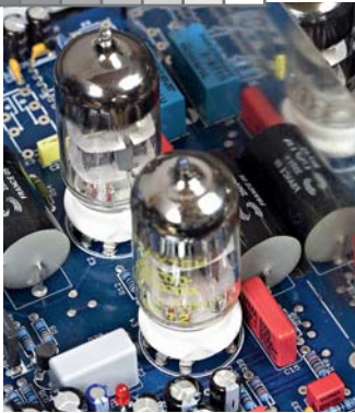
Na wyjściu lampy próżniowe – podwójne triody 12AX7EH oraz 6922EH Electro-Harmonixa.
