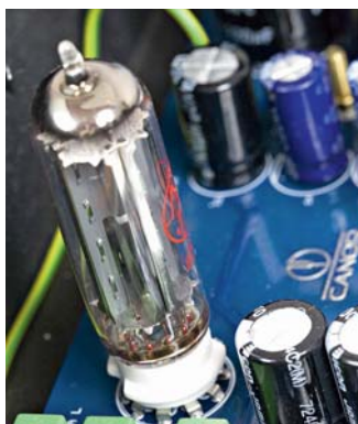
To rzecz jeszcze rzadziej spotykana – napięcie anodowe lamp prostowa- ne jest w lampowym, pełnokreso- wym prostowniku.
