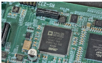
Potężny procesor DSP Analog Devices, spotykany kiedyś tylko w technologicznie zaawansowanych amplitunerach AV; tutaj służy do obróbki sygnału, magazynowanego w buforze pamięci.
