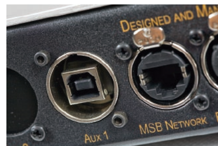
Gniazdo USB dla sygnałów 32/384, a obok RJ-45; służy tutaj do transportu sygnału z napędu do DAC-a, z oddzielnymi liniami zegara i obydwu kanałów.
