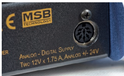
Wielopinowy DIN z trzema różnymi napięciami dla DAC-a – dwoma dla sekcji cyfrowej (przetwornik i filtry) i jednego dla analogowej.
