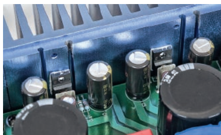
Do radiatorów przykręcono układy stabilizujące napięcie.
