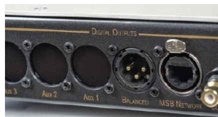
Obok aktywnych wyjść znajdują się zaślepienie otwory, przeznaczone dla gniazd wyjścia wielokanałowego – MSB deklaruje, że jest w stanie przygotować wielokanałowe źródło cyfrowe.
