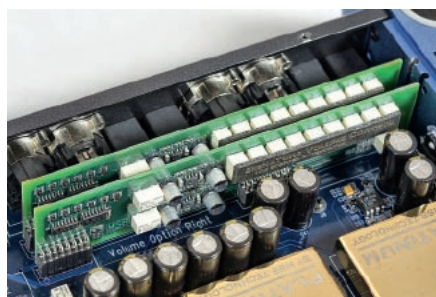
Układ regulacji wzmocnienia oparto na przełącznikach i opornikach.
