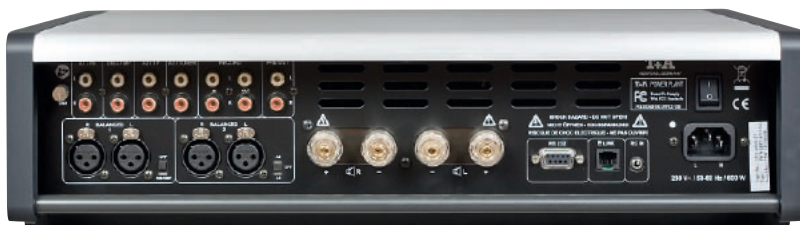
Tylna ścianka jest cofnięta, dzięki czemu można chronić wtyczki i ukryć częściowo wystające kable.
