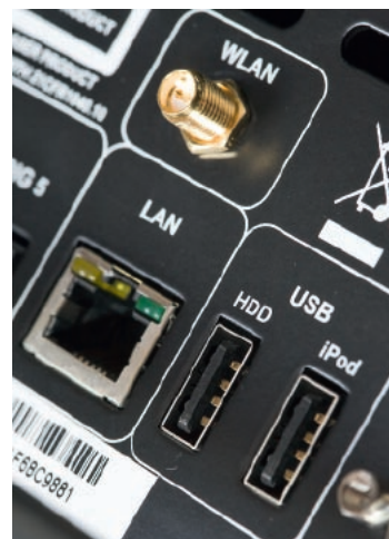
Esencja odtwarzacza strumieniowego - przewodowe gniazdo LAN, konektor dla anteny Wi-Fi oraz dwa porty USB.
