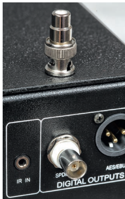
Wyjście cyfrowe SPDIF transportu przygotowano na gnieździe BNC - do współpracy z C5i jest konieczna przejściówka, którą znajdziemy w komplecie.
