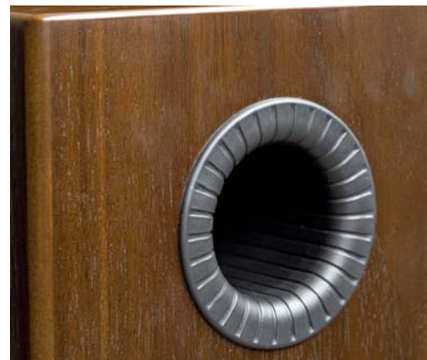
Otwór bas-refleks w górnej części tylnej ścianki nie obsługuje głośnika średnionowego, ale jest wyprowadzony, podobnie jak otwór na przedniej ściance, ze wspólnej komory głośników niskotonowych.
