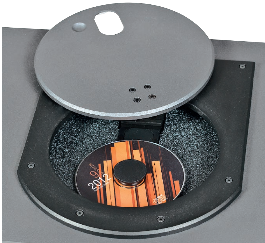
Komora na płytę jest w Eposie znacznie większa niż zazwyczaj. Płytę wkłada się więc i wyjmuje bardzo wygodnie.
