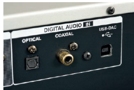
USB z tyłu jest przeznaczone do podłączenia komputera jako źródła sygnału.
