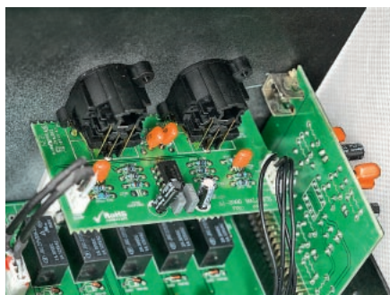
Sygnał zbalansowany, tuż za wejściami XLR, jest zamieniany na Single-Ended i jako taki trafia do sekcji przedwzmacniacza.
