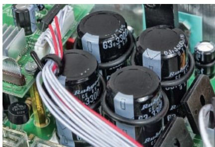
Tłumienie drgań to również zajęcie dla projektantów Arcama, w związku z tym gumowe ringi na kondensatorach Rubycony w zasilaczu.
