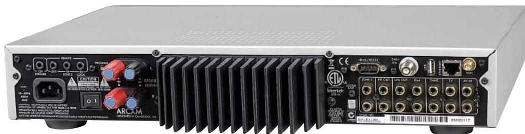
Z tyłu widać duży radiator, rozsądnie wyprowadzony na zewnątrz tak kompaktowego urządzenia.
