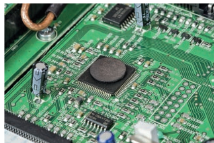
Jeden z układów DSP, a na nim charakterystyczny dla Arcama krążek ferrytowy, tłumiący promieniowanie RF.
