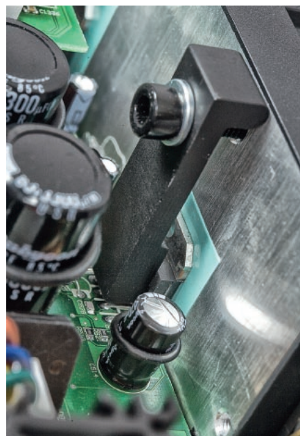
Jeden z układów DSP, a na nim charakterystyczny dla Arcama krążek ferrytowy, tłumiący promieniowanie RF.
