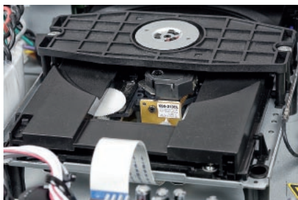
Napęd to klasyczna jednostka, przygotowana niegdyś przez Sony, a teraz dostępna w wielu wersjach od różnych producentów.
