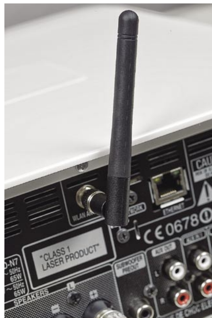
Port sieci LAN i antena dla bezprzewodowej sieci Wi-Fi – to dzisiaj standardy nowoczesnego systemu.
