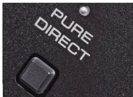
Układ Pure Direct odłącza regulatory barwy i wyświetlacze.
