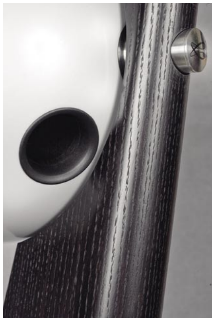
Z jednej strony statywu pojawia się wylot bas-refleksu – to ważna cecha kulistej konstrukcji, dzięki której przetwarzane pasmo sięga dostatecznie nisko, aby ustalać zdrowe, niskie podziały z subwooferem, a nawet próbować stosować Baltiki samodzielnie.
