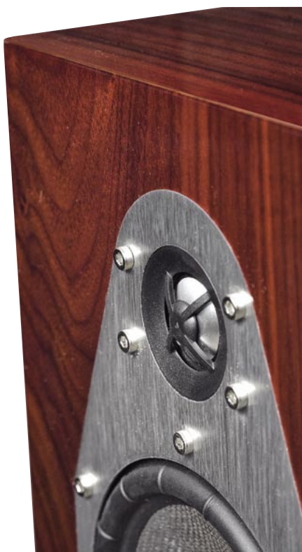
Aluminiowa kopułka wysokotonowa osłonięta jest „krzyżakiem” i otoczona aluminiową płytką, obejmującą też kosz głośnika średniotonowego. Tandem ten producent nazywa modulem CSM, który dzięki bliskości obydwu przetworników może zapewnić dobre charakterystyki kierunkowe.
