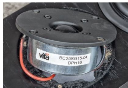
Głośnik wysokotonowy to kopulka ViŃy popularnej od wielu lat serii BC.
