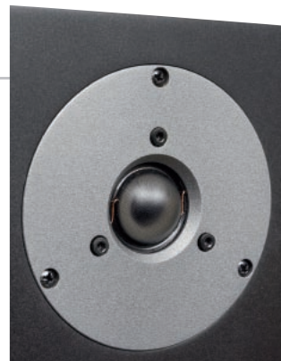
Klasyk nad klasykami – 28-mm jedwabna kopułka Dynaudio z charakterystycznymi „włosami” doprowadza do cewki (po tym odróżnimy ją od 28-mm kopulek Scan-Speaka).
