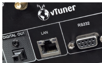
W przypadku radia internetowego to podstawowe gniazdo – LAN. Nad nim logo vTuner – platforma internetowa www.vtuner.com integruje wiele firm, oprócz NAD-a również Arcama, Denona, Harmana i inne.
