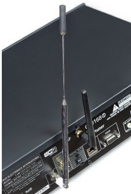
Dwie anteny (na wyposażeniu) – mniejsza Wi-Fi i duża dla radia DAB.
