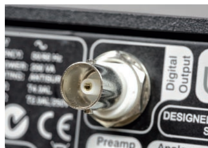
Gniazdo cyfrowe (wyjściowe) to prawdziwie 75-omowy BNC.
