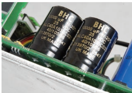
W zasilaczu zamontowano znakomite kondensatory BHC z czterema wyprowadzeniami.
