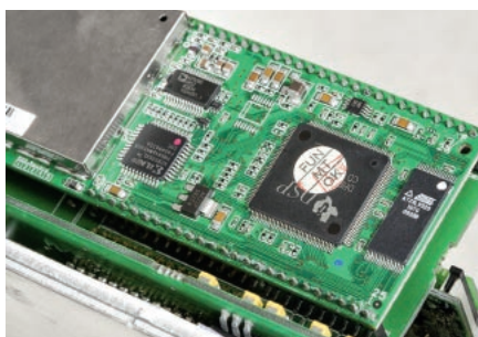
Kompletne radio DAB i FM – to ostatnie jest obrabiane w domenie cyfrowej.
