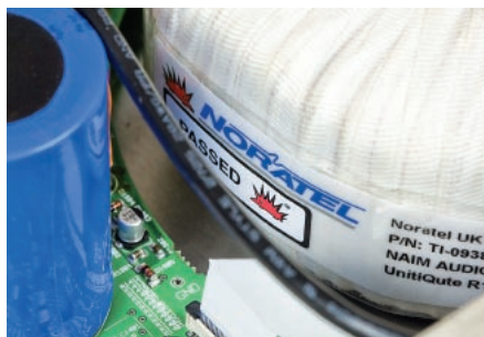
Podstawa zasilania – duży transformator zasilający firmy Noratel.
