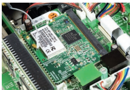
Płytkę z układem sieci WLAN, a pod spodem kompletny odtwarzacz plików, wpinany do płytki głównej.
