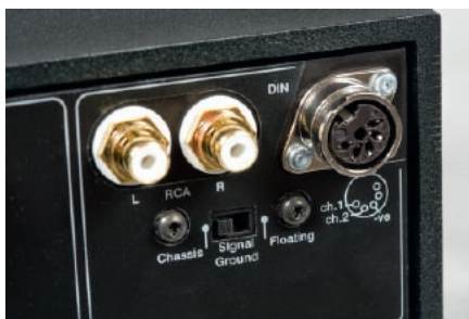
Gniazda DIN; teraz są też gniazda RCA, jednak kiedyś, jeśli chcieliśmy połączyć Naima z urządzeniem innej firmy, musieliśmy korzystać z przejściówki. Pod gniazdami przełącznik odłączający masę sygnału od obudowy.
