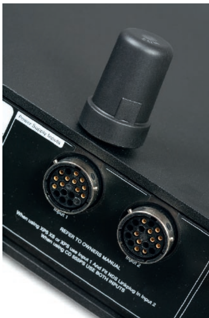
Naim od lat wskazuje na zalety płynące z wydzielenia zasilacza do oddzielnej obudowy. W NDS-ie mamy osobno zasilane sekcje cyfrową i analogową. Jeśli korzystamy z najtańszych zasilaczy, jedno z wejść zaślepiamy dotychczasowym do kompletu „dzyndzlem”.
