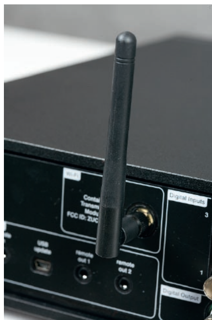
Łącze bezprzewodowe Wi-Fi to sensowne rozwiązanie, jeśli słuchamy muzyki „w tle”. Lepsze brzmienie uzyskamy jednak z łącza przewodowego LAN.
