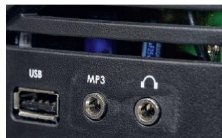
Wejścia podręczne umieszczono z boku, port USB zapewnia możliwość odczytu plików MP3 i WMA.
