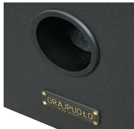
Grajpudło to graj-refleks. Optymalną częstotliwość rezonansową uzyskano bez pomocy dodatkowego tunelu (masę powietrza utrzymuje tylko grubość przedniej ścianki). To faktycznie przywołuje na myśl dawne konstrukcje, w których nie forsowano bardzo niskiego strojenia. W razie nadmiaru basu otwór można zamknąć, w tym celu należy w nim zainstalować krótki, częściowo wypełniony twardą gąbką tunel, pełniący rolę zatyczki.
