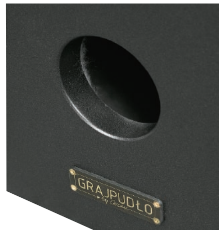
Grajpudło to graj-refleks. Optymalną częstotliwość rezonansową uzyskano bez pomocy dodatkowego tunelu (masę powietrza utrzymuje tylko grubość przedniej ścianki). To faktycznie przywołuje na myśl dawne konstrukcje, w których nie forsowano bardzo niskiego strojenia. W razie nadmiaru basu otwór można zamknąć, w tym celu należy w nim zainstalować krótki, częściowo wypełniony twardą gąbką tunel, pełniący rolę zatyczki.
