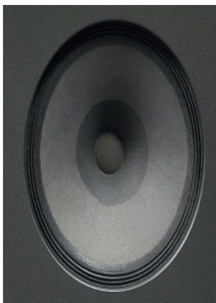
Celulozowa membrana w głośnikach niskotonowych to żadne „halo” – jest stosowana zarówno w popularnych, jak i hi-endowych zespołach głośnikowych. Ta jest jednak wyjątkowa – z bardzo małą nakładką centralną, sygnalizującą też niewielkiej średnicy cewkę, i „twardym” górnym zawieszeniem uformowanym z zewnętrznej części samej membrany.
