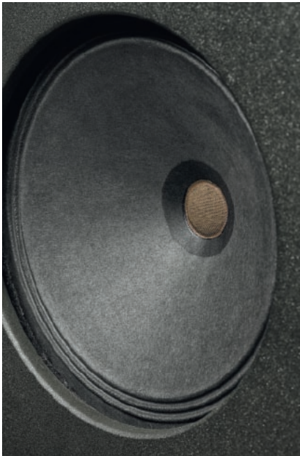
Głośnik pracujący nominalnie jako średniotonowy jest wyjątkowo duży – i jego możliwości są w pełni wykorzystane, jest filtrowany bardzo nisko, mając udział w przetwarzaniu basu jeszcze w okolicach 100 Hz. To prawdopodobnie wcale nie specjalizowany głośnik średniotonowy, lecz produkt pochodzący z czasów, kiedy był on po prostu... głośnikiem – stosowanym jako jedyny w całej „instalacji” (np. dużym radiodbiornikiem).
