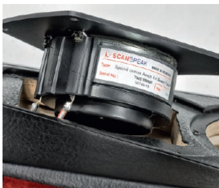
Również na wysokotonowym znajdziemy nazwę producenta, który razem z innymi skandynawskimi firmami od dawna „zabezpiecza” głośnikowe zaplecze Sonusa, a tym razem dostarcza obydwie przetworniki potrzebne w Guarneri Evolution .
