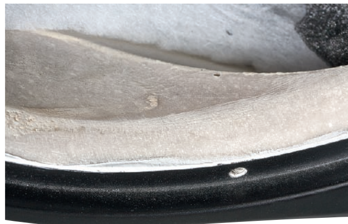
Skorupę obudowy wykonano z kompozytu, którego głównym składnikiem jest kruszony marmur.
