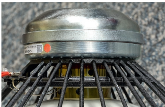
W układzie magnetycznym, opartym na 12-cm pierścieniu neodymowym, pracuje cewka o średnicy 55 cm, nawinięta na tytanowym karkasie.
