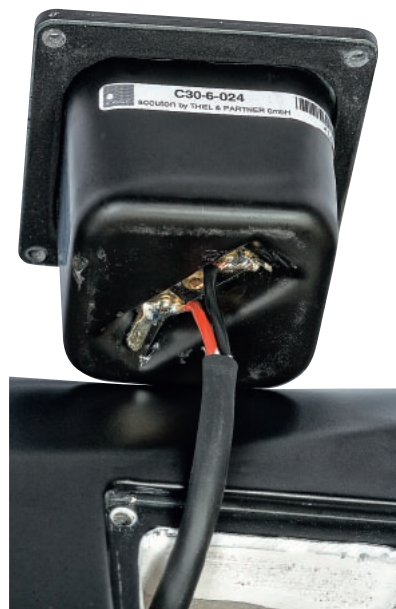
Klasyk w ofercie Accutona – 30-mm kopułka wysokotonowa, stosowana nie tylko w towarzystwie innych przetworników tej firmy.
