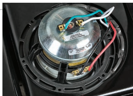
Średnio-wysokotonowy moduł koncentryczny jest z innej półki. Zaprojektowany niedawno we współpracy ze Scan-Speakiem, produkowany przez Duńczyków tylko dla Vienny, ma aerodynamiczny kosz, a przede wszystkim układ magnesów neodymowych – również dla przetwornika średniotonowego.
