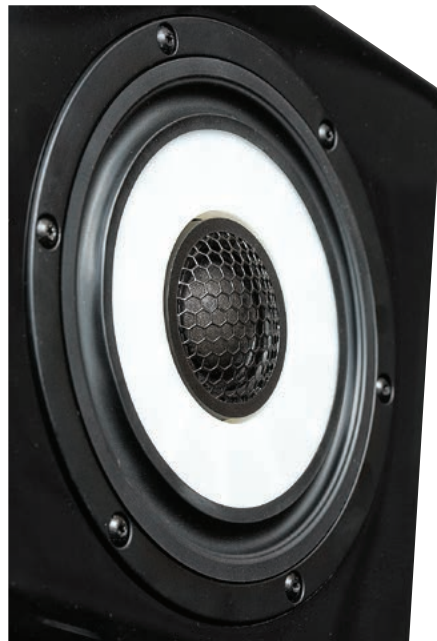
Koaksjalny moduł średnio-wysokotonowy przygotowano wedle przepisu: wokół kopułki wysokotonowej utworz płaską membranę przetwornika średniotonowego, a zminimalizujesz dyfrakcje i zapewnisz szerokie rozpraszanie. 30-mm jedwabna kopułka wysokotonowa została osłonięta siateczką. Miękkich kopulek zwykle się tak nie zabezpiecza, ale w tym przypadku wielkość „oczek” gwarantuje bezproblemowe promieniowanie. Szczelina między wysokotonowym cylindrem a membraną średniotonową powinna być jak najmniejsza, aby nie stać się „akustyczną pułapką” i nie wywoływać dyfrakcji.
