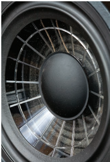
...„Pajęczna membrana”, czyli wzmocnienie membrany niskotonowej (od tylnej strony), występuje w kolumnach Vienny, w głośnikach niskotonowych, od wielu lat. Rozwiązanie skuteczne i dobrze widoczne dzięki przezroczystości materiału membrany, który jednak nie został wymyślony na potrzeby tego rozwiązania – to już wcześniej stosowany polimer XP, wprowadzony przez Seasa ok. dwadzieścia lat temu jako lepszy od zwykłego polipropylenu.
