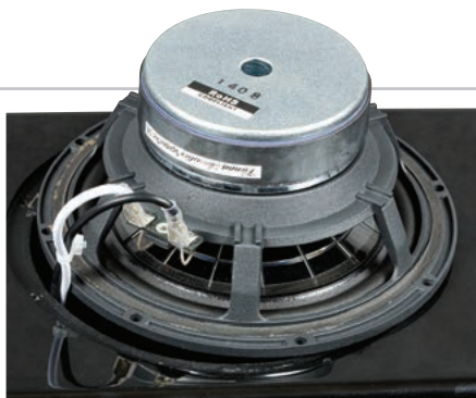
Kosz głośnika niskotonowego ujawnia jego rodowód – to „17-tka” Seasa, jeszcze bez profilowanych żeber i wentylacji pod dolnym zawieszeniem, z przeciętnej wielkości (90-mm) układem magnetycznym. Ale membrana jest specjalna...
