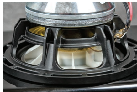
Płaski profil membrany jest korzystny dla znajdującego się w jej centrum przetwornika średniotonowego, ale ona sama staje się słabsza, bardziej podatna na odkształcenia – dlatego musi zostać usztywniona, i to wyraźnie większymi żebrami niż stożkowa membrana głośnika średniotonowego.
