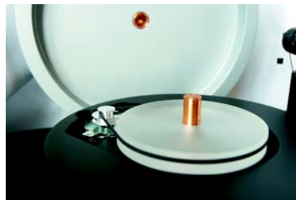
Moment obrotowy przenoszony jest paskiem z silnika na akrylowy subtalerz.
