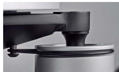
Aby ograniczyć ruch w płaszczyźnie poziomej, subchassis zawieszono na grubych gumowych ringach.
