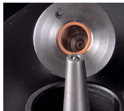
Odwrócone główne łożysko (talerza) – widać kulkę, a z tyłu stożek z łożyskiem.
