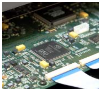
Kość Sony dekoduje strumień DSD, mamy też czip Sony służący do sterowania samym napędem.
