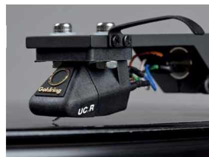
Wkładka Ucello Reference to model MM – selekcyjowana wersja Goldringa 1042 Reference.
