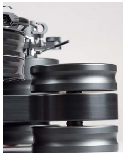
Stopy gramofonu – podstawa jest w nich mocowana na sztywno. Poziom reguluje się poprzez kręcenie górną częścią stopy.
