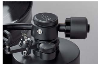
Choć ramię TR-800S wygląda jak unipivot, jest to klasyczne zawieszenie kardanowe – ale bez zewnętrznej obejm, zamknięte w tulei.
