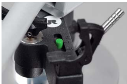
Ramiona Regi wyposażone są w prosto, acz bardzo elegancko rozwiązany antyskating – magnetyczny.
