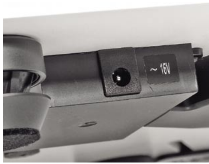
Zasilanie podpięte jest do gniazda pod spodem podstawy, w plastikowej osłonie.
