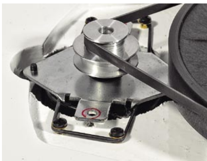
Silnik zawieszony jest na gumce odsprężającej go od podstawy.
