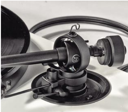
Ramię typu gimbaled, z kardanowym zawieszaniem - widać gniazda łożysk, zakręcane od zewnątrz specjalnymi kapturkami. Na mosiężnej przeciwwadze zamontowano plastikową tarczę, na której naniesiono skalę w gramach.
