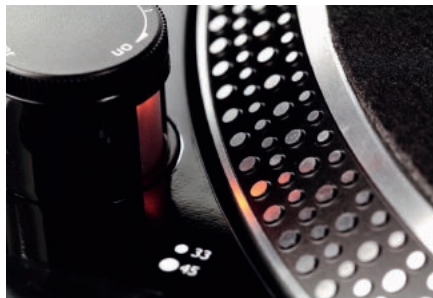
USB-1 wyposażony jest w regulację prędkości obrotowej, opartej na karbowanym talerzu, neonówce i suwaku. Na neonówce znalazł się wyłącznik silnika.
