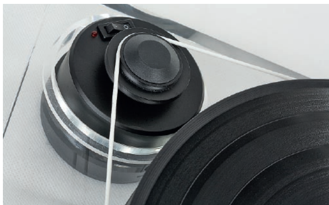
Silnik jest stawiany w otworze podstawy tak, aby jej nie dotykał. Pasek napędowy wykonano z białej gumy o okrągłym przekroju.
