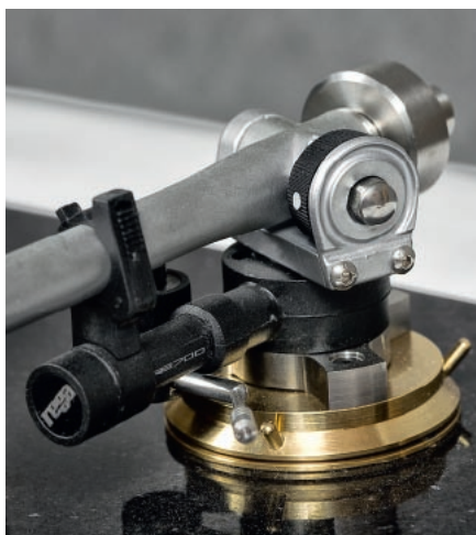
Regulacja VTA odbywa się w gramofonie – poprzez obracanie mosiężnego pierścienia.
