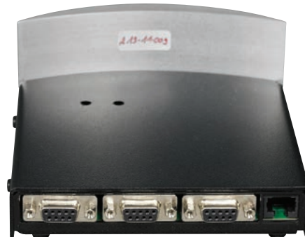
Sterownik silnika od tyłu – możemy podpiąć aż trzy silniki.
