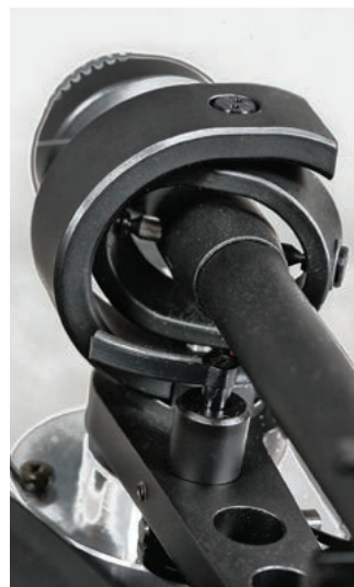
Klasyczne, kardane zawieszenie ramienia zostało zbudowane z hartowanych ostrzy i regulowanych punktów, w których są oparte. Mniejsza obejma została przesunięta w stosunku do ramienia pod takim samym kątem jak główka ramienia.
