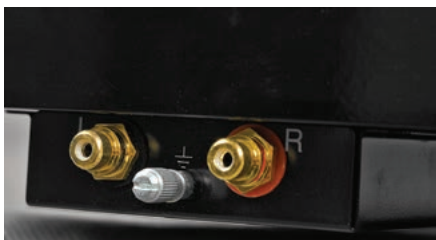
Gniazda RCA są mocowane w metalowej puszcze wypuszczonej pod obrys podstawy.
