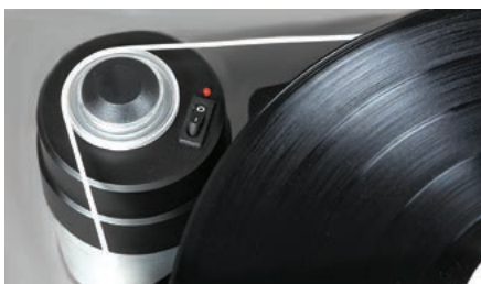
Synchroniczny silnik Pro-Jecta umieszczono na wysokim, aluminiowym walcu, który wynosi oś silnika na wysokość, na której znajduje się talerz.
