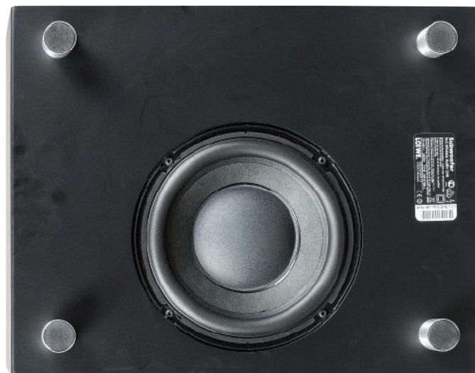
18-centymetrowy głośnik niskotonowy zainstalowano w dolnej ścianie; wraz z dużą objętością obudowy potrafi zdobyć się na mocne kinowe efekty.
