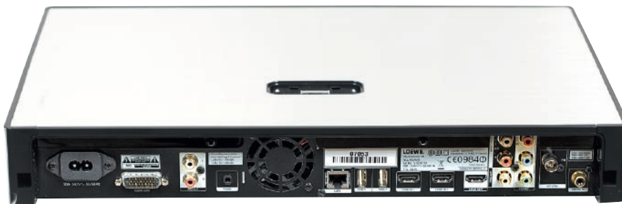
Pokrywa została przedłużona, tworząc „nawis” ochraniający wtyczki przewodów. Stację dokującą wbudowano centralnie, bez jakiegokolwiek zastony.
