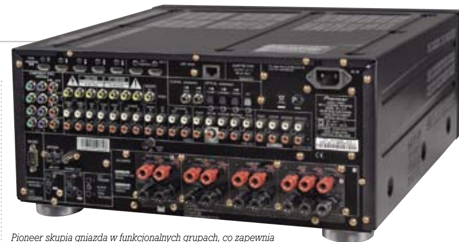
Pioneer skupia gniazda w funkcjonalnych grupach, co zapewnia łatwiejszą orientację w podłączeniach.
