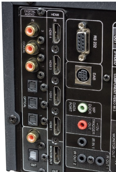
Cały moduł wejść cyfrowych (w tym HDMI) i kryjące się za nim układy procesorów można w łatwy sposób wymienić.
