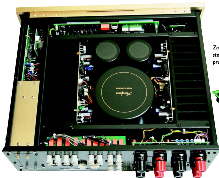
Końcówka mocy zmieściła się na płytce przykręconej bezpośrednio do masywnego radiatora.
