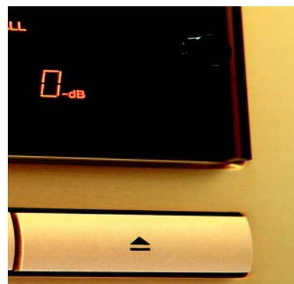
Wyświetlacz DP-500 podzielono na dwie sekcje. Na jednej z nich znajdziemy poziom sygnału wyjściowego – tradycyjnie regulowany w odtwarzaczach Accuphase.
