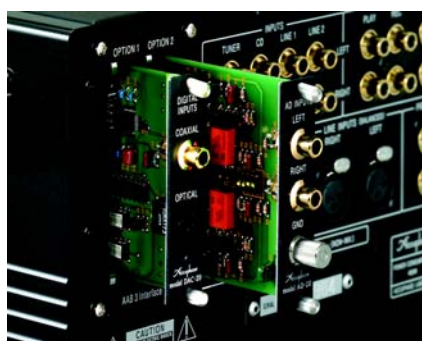
We wzmacniacz Accuphase można wpiąć opcjonalne karty, np. wysokiej klasy przedwzmacniacza gramofonowego, przetwornika D/A lub dodatkowych wejść liniowych.
