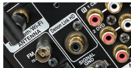
Denon Link, trochę już zapomniany, ale wciąż obecny w droższych modelach – to firmowy interfejs transmisji, gwarantujący niskie zniekształcenia jitter.
